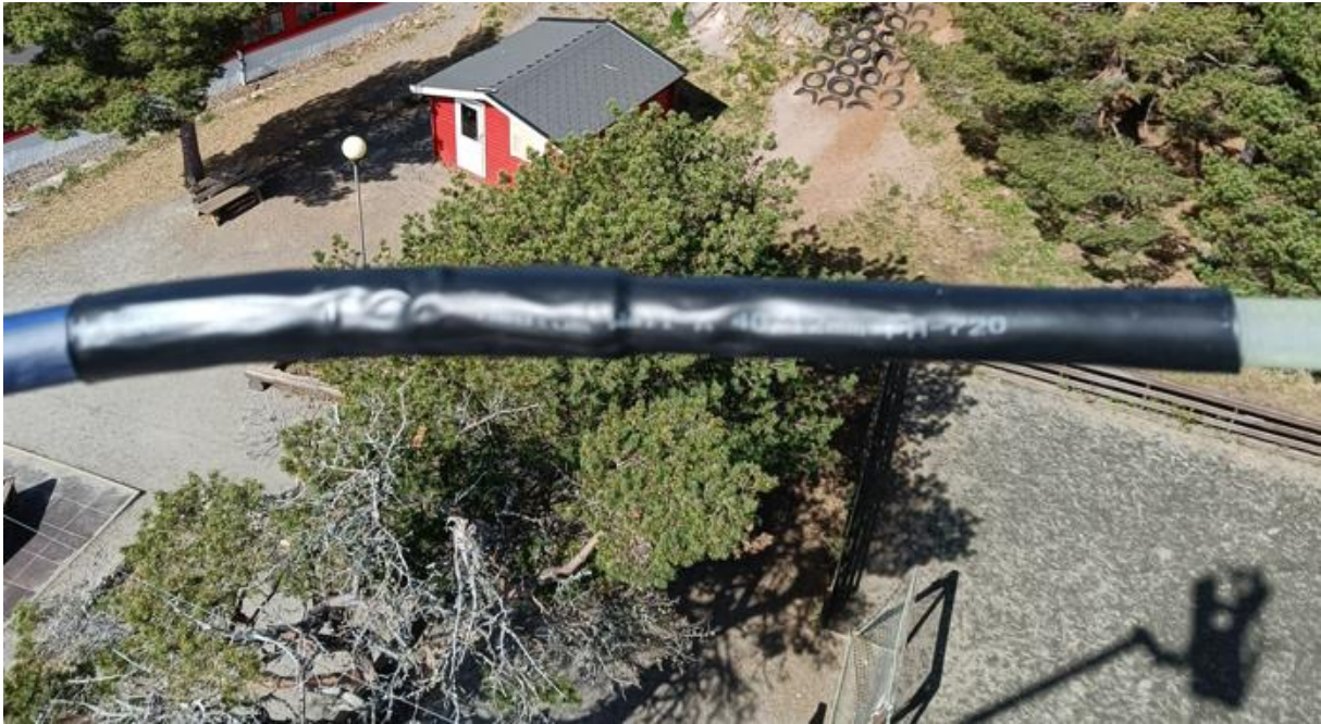
Bilde 6, Viser en kraftig krympestrømpe mellom buen (blå) og elementrøret (hvit). (Bilde LA1ITA)
